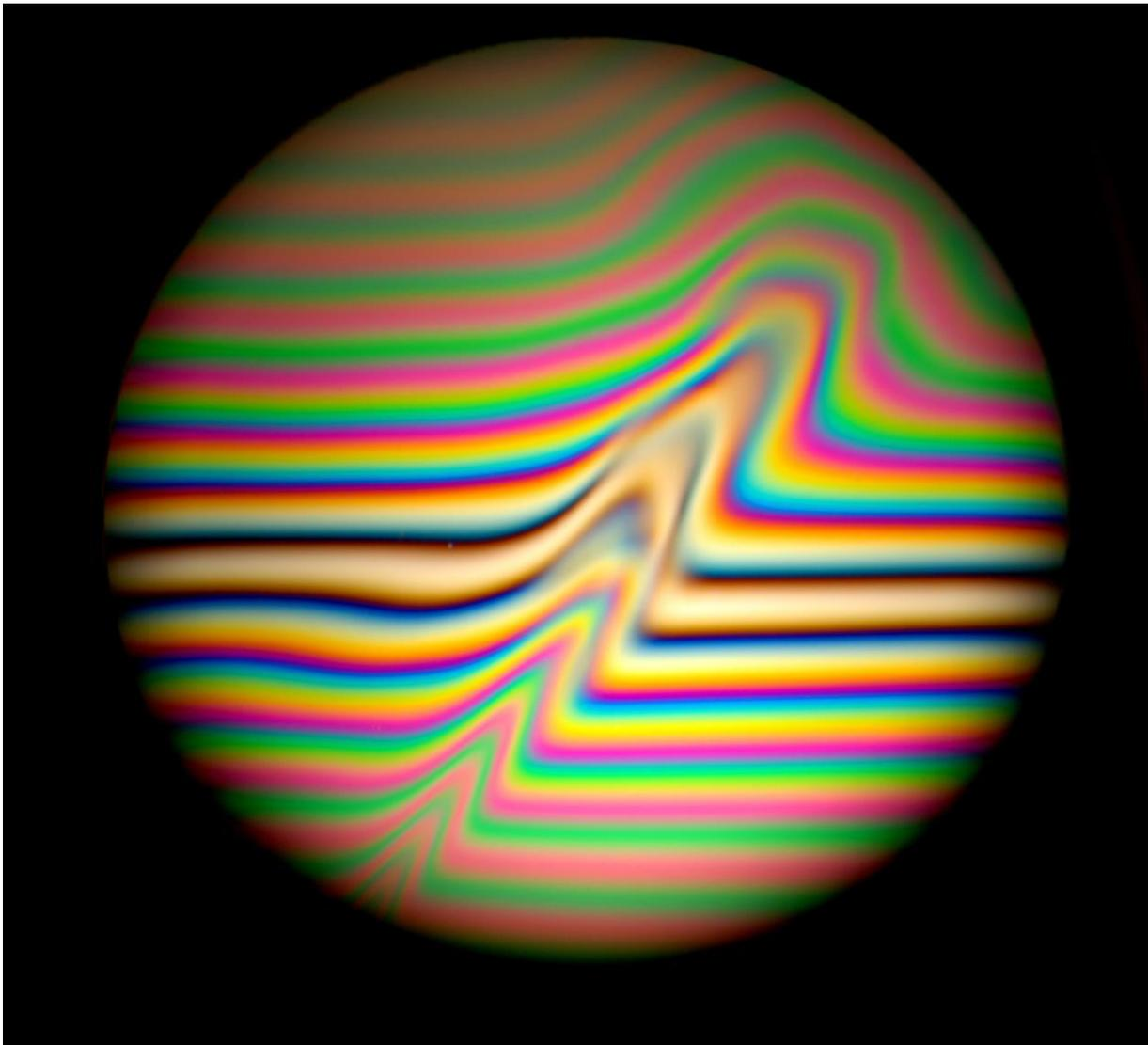
Figure d'interférences obtenue avec l'interféromètre de Michelson (coin d'air)
