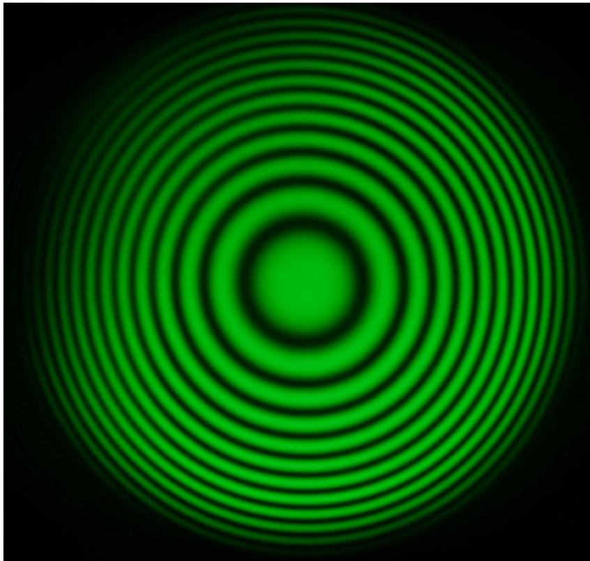
Figure d'interférences obtenue avec l'interféromètre de Michelson (lame d'air)
